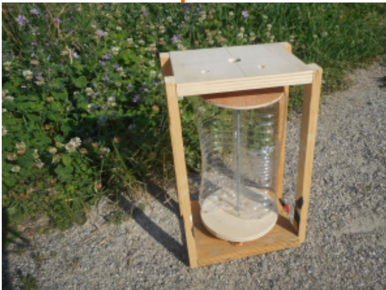
Construction d'une petite éolienne constituée de bouteilles recyclées, d'une structure en bois et d'un générateur, qui allume une diode lorsque les pâles tournent.
