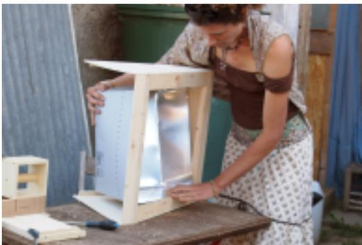
Le four solaire "Ulog" est un modèle de petit four solaire, qui atteint une température d'environ 110°. Il permet de faire des cuissons lentes grâce à l'énergie du soleil !
